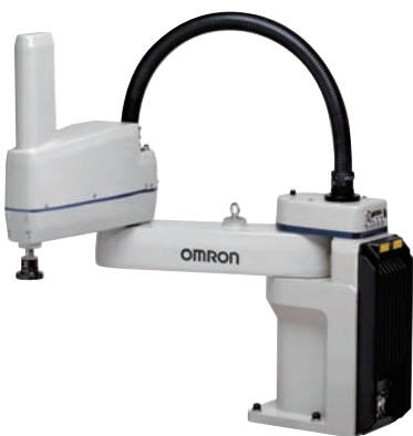
SCARA EtherCAT slave robot
